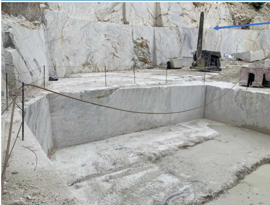
Fig.35 _allargamento base con gradoni lato nord
