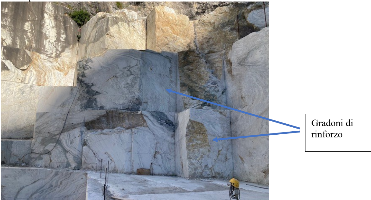
Fig.34 _allargamento base con gradoni lato ovest nord-ovest
