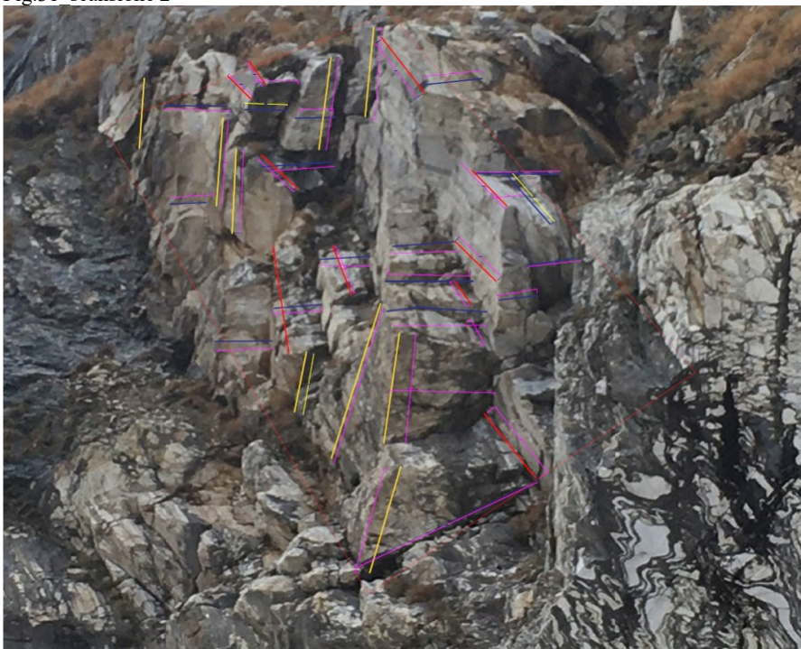
Fig.32 _scansione 2 in rosso le fratture K1, in blu le K2 ed in Giallo le K2 , in viola la spaziatura tra le fratture
